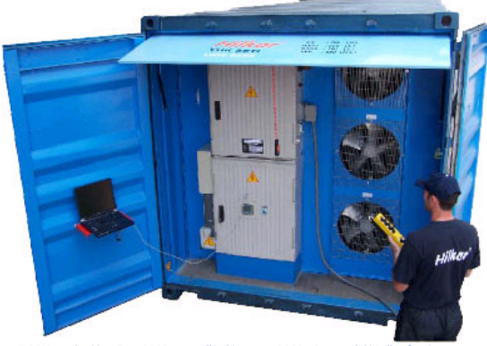
725 kW rezistif + 500 kVAr endüktif + 100 kVAr kapasitif Yük Seti
